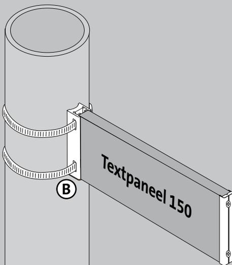
Mit dieser Variante lassen sich Textpaneele an Fassaden (Linealprofil) oder auch Richtungsweiser (Nutprofil) an Rohrfosten befestigen und umsetzen. Unsere Textpaneele bieten durch mehrere Höhen eine Vielzahl von Anwendungen.
